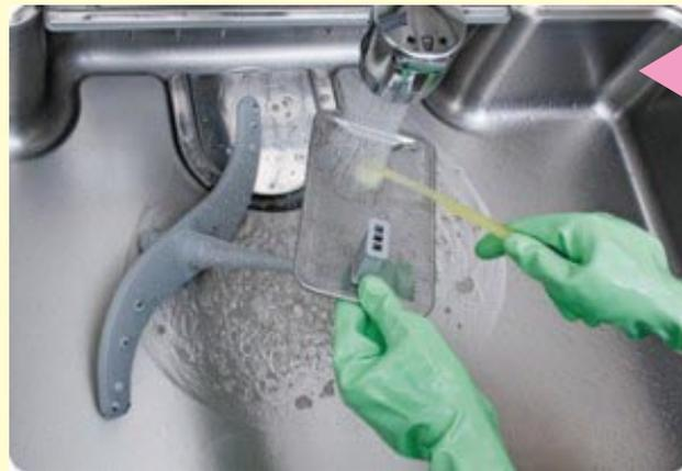
④ ノズルと残さいフィルタは、水で洗い流しながら歯ブラシで汚れを落とします。
