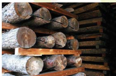
木材中の水分を抜く為 20 日間乾燥を行います
