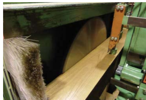
削り取られたオガ屑は、オガ貯蔵庫へ運ばれますので、周りには飛び散りません
