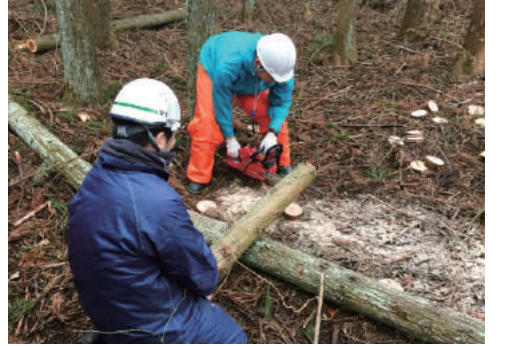
伐採した木を切り運びます。 この日は、丸太を決まった長さにブツ切りにする「玉切り」の練習をしました。
